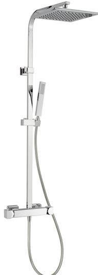
Columna termostática ducha 2 funciones, deviastop 2 salidas, columna telescópica, soporte duchita corredizo, duchita una función minimalista 35x15 mm Latón, rociador cuadrado 300x300 mm de LATÓN, flexible liso SUPREME 150 cm
